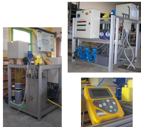
Pilote de méthanisation et analyseur biogaz (PFT GH 2 O)
