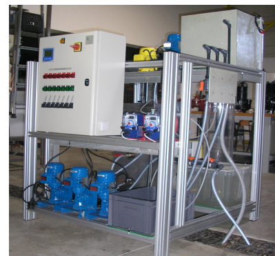
Pilote de méthanisation (PFT GH 2 O)
