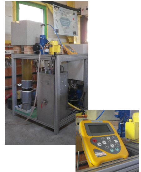
Pilote de méthanisation et analyseur biogaz
