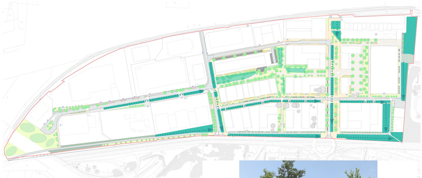
UN SYSTÈME DE NOUES GÉRANT LES EAUX DE PLUIE
