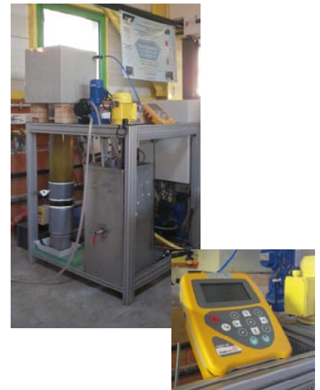
Pilote de méthanisation et analyseur biogaz
