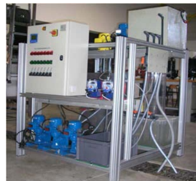
Pilote de méthanisation (PFT GH 2 O)
