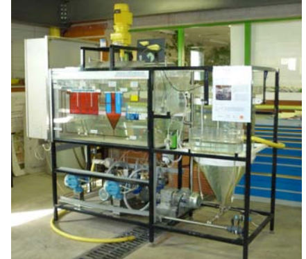
Pilote de station d'épuration à boues activées (PFT GH 2 O)
