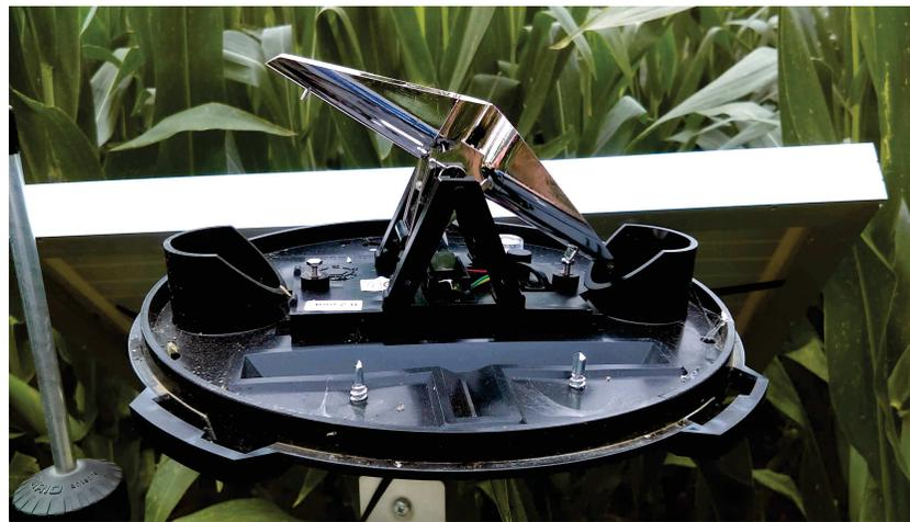
*Pluviomètre à bascule*
